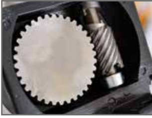
Dişli Metal santrafuj dişli Frenli sistem
