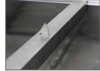
Sır Alma Çubuğu AISI 304 paslanmaz
